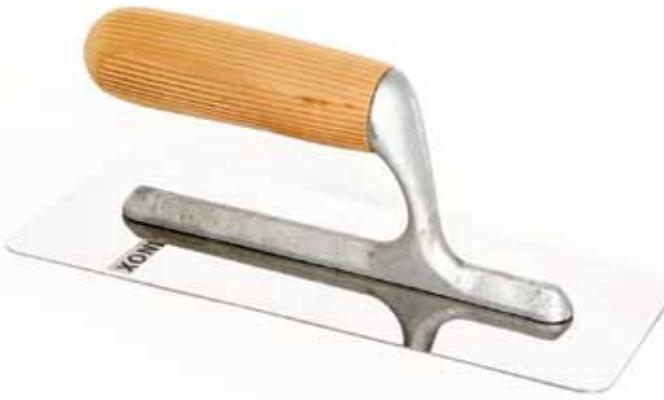
Frattazzo di tipo USA. Questo articolo è dotato di manico in legno rigato con fustella in alluminio pressofuso e piano liscio in acciaio inox con angoli arrotondati.
